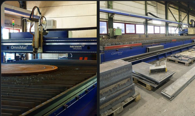
Messer OmniMat L5000 Autogen Alfa 20 000 × 3 500 мм · до 200 мм · фаски ±45°
