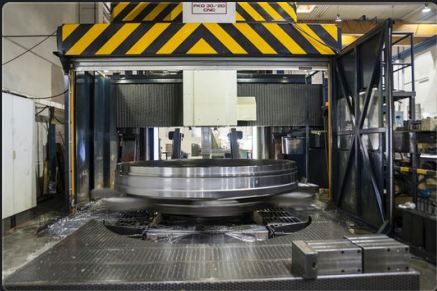
Feichter FKD30/20 Vertikalna karusel tokarilica
