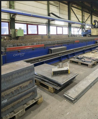
Messer OmniMat L5000 Autogen Alfa 20 000 × 3 500 mm · jusqu'à 200 mm · chanfreins ±45°
