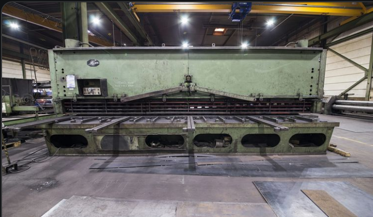
剪板机 剪切长度 6,100 毫米 · 板厚达 15 毫米
