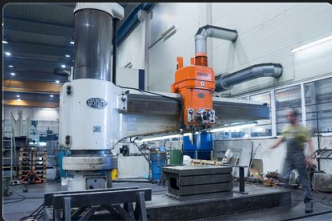
Raboma 12UH 3000 Radiaalboormachine
