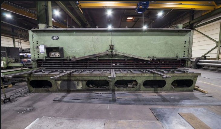
Plateklipper Skjærelengde 6 100 mm · plate opptil 15 mm
