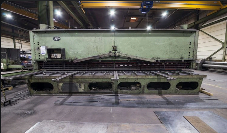
Cizalla guillotina Longitud de corte 6.100 mm · chapa hasta 15 mm
